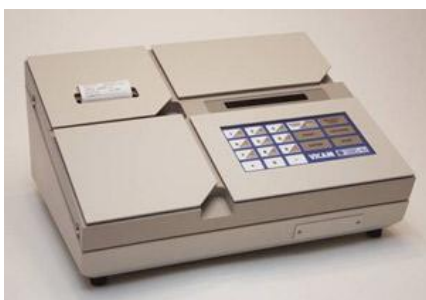
FIGURA 1 : FLUORIMETRO VICAM PER LA DETERMINAZIONE DELLE AFLATOSSINE DEL MAIS
